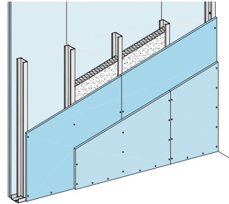
Теплоизоляция стен с обрешеткой и обшивкой ГКЛВ.
